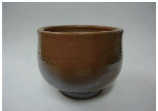
図4(b) しじみの貝殻と共に酸化雰囲気下で1280℃-30min焼成した試験体
