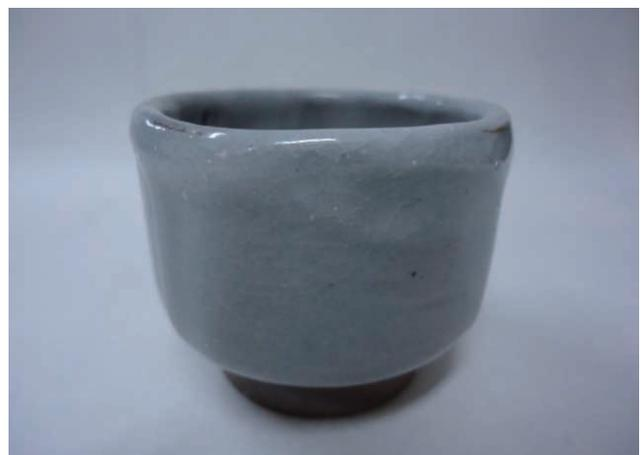
図1(b) 釉薬①を施釉し、還元雰囲気下で1280℃-30min焼成した試験体
