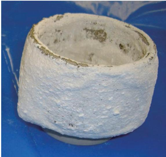
図2 釉薬②を施釉し、酸化雰囲気下で1280℃-30min焼成した試験体
