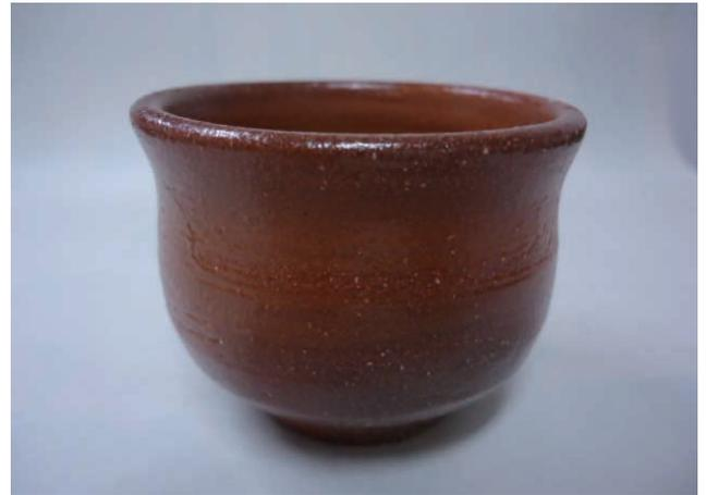
図4(a) 岩牡蠣の貝殻と共に酸化雰囲気下で1280℃-30min焼成した試験体
