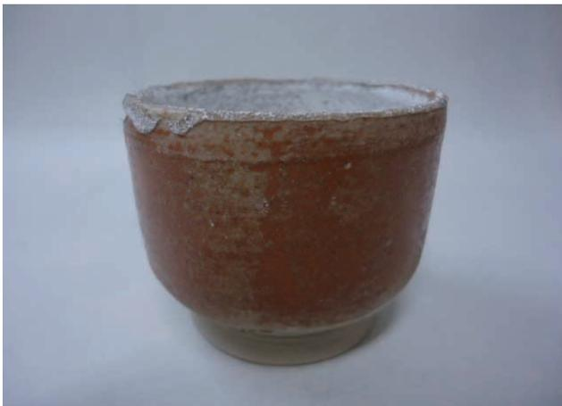
図3 図2の試験体を覆う白い厚膜を除去した試験体
