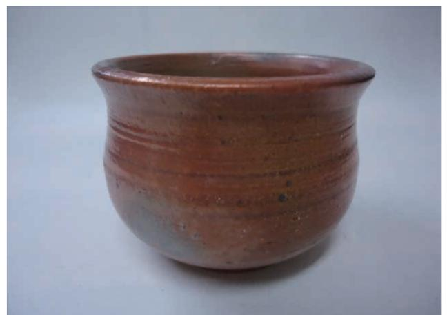
図5 岩牡蠣の貝殻と共に還元雰囲気下で1280℃-30min焼成した試験体
