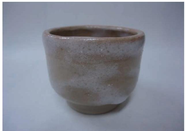
図1(a) 釉薬①を施釉し、酸化雰囲気下で1280℃-30min焼成した試験体
